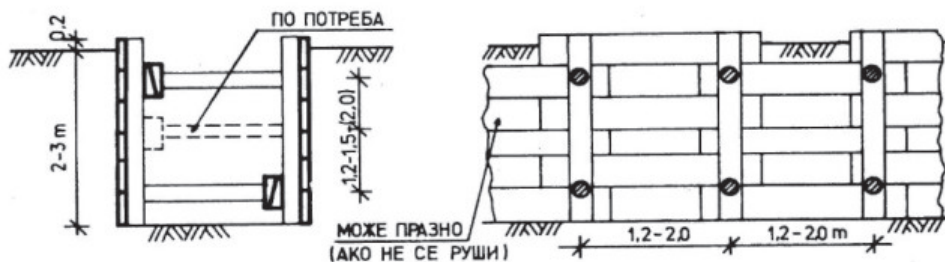
Сл.9.6. Заштита на градежната јама со хоризонтални талпи: а) попречен пресек; б) подолжен пресек
