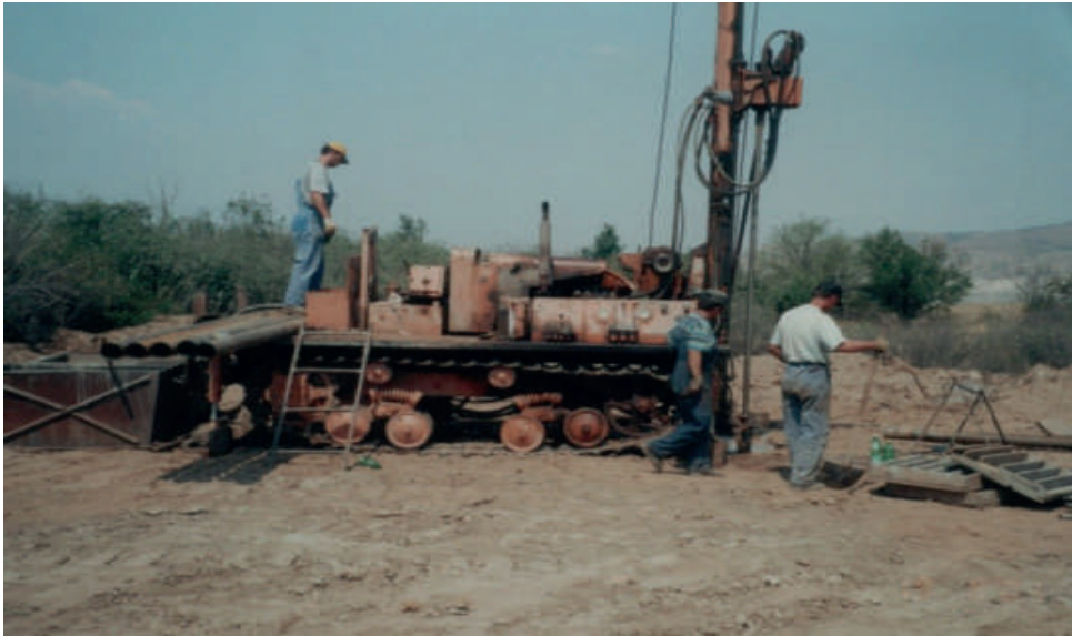
Сл.4.6. Подвижна машина за ротационо дупчење на гасеници при изведба на дупнатина за истражување на јаглен при П.К.Суводол-Битола
